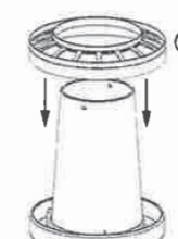
ABBILDUNG 4 Führen Sie den Anti-Abfall-Ring durch den Oberteil und befestigen Sie ihn am Unterteil.
