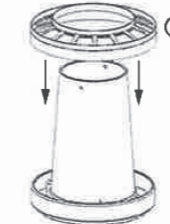
FIGURA 4 Pase el anillo antidesperdicio a través del cono y encájelo sobre el plato.
